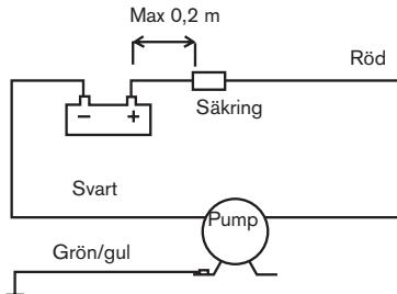
Andra elektriska anordningar, t.ex. strömbrytare, reläer ska placeras mellan pump och batteriets pluspol (+) (på den röda kabeln).
