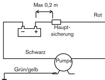
*Andere Elektrogeräte, z.B. ein Schalter, ein Leistungsschalter müssen zwischen der Pumpe und der positiven (+) Leitung an die Batterie (an den roten Draht) eingebaut werden.*
