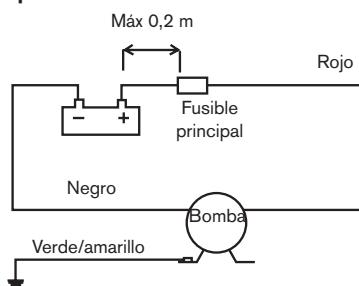
Otros dispositivos eléctricos, ej. interruptores, cortacircuitos, deben instalarse entre la bomba y el terminal positivo (+) de la batería (sobre el cable rojo).
