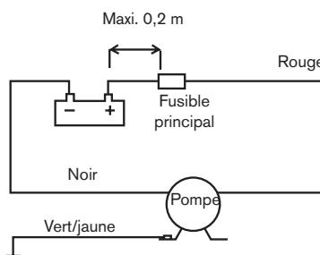
Les autres accessoires électriques, interrupteur, disjoncteur, etc., doivent être installés entre la pompe et la polarité positive (+) de la batterie (sur le fil rouge)
