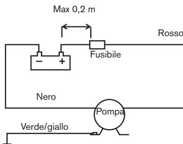
Altri apparecchi elettrici, p. es. interruttori, interruttori automatici, devono essere installati fra la pompa e il polo positivo (+) della batteria (sul cavo rosso).
