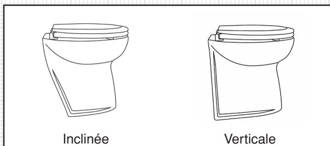
Les deux cuvettes diffèrent seulement dans la forme de l'arrière du W.C. La version à dos incliné réduit l'empreinte au sol et permet une fixation aisée contre une surface inclinée ou en coin. La version verticale permet une fixation tout contre une cloison verticale.
