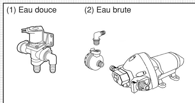
**(1) Les modèles 58060 et 58080 Series** sont fournis avec un bloc électrovanne/anti-siphon à raccorder à tout système d'eau pressurisé capable d'un débit de 11 l/min. ou plus. L'anti-siphon permet d'assurer qu'il n'y a aucun reflux du W.C. dans le système d'eau.
